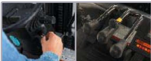
▲ **Le commutateur d'allumage surélevé et le levier de libération du frein de stationnement** ont été judicieusement placés de façon à ce que l'opérateur n'ait pas à se pencher vers l'avant sur son siège.
