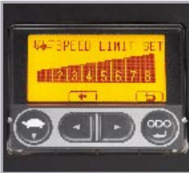
▲ **La fonction de commande de vitesse du véhicule<sup>1</sup>** peut être programmée au moyen de l'affichage numérique; cela permet de régler automatiquement la vitesse maximale de déplacement du chariot élévateur pour répondre à une vaste gamme d'applications et selon les niveaux d'aptitude de l'opérateur.
