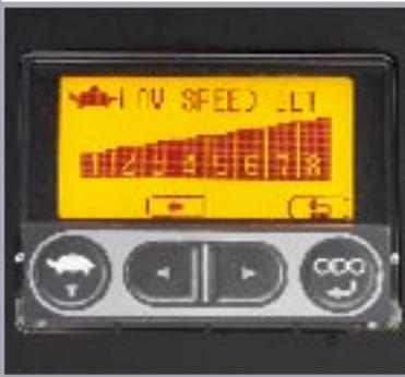
▲ **La fonction de paramétrage à faible vitesse<sup>1</sup>** peut s'utiliser pour limiter, sur pression d'une touche, la vitesse de déplacement maximale du chariot à une valeur prédéfinie pour les applications demandant diverses vitesses de déplacement.
