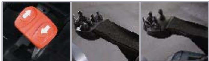
▲ La pédale EZ en option permet à l'opérateur de changer rapidement et facilement la direction de déplacement sans retirer les mains du volant ou des commandes hydrauliques.
