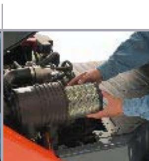
▲ **Le filtre à air haut débit en 2 étapes à joint radial** est facile à changer, ce qui permet d'intervenir plus rapidement. Sa surface très plissée offre un excellent piège à la saleté.
