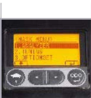
▲ **Le mode analyseur** affiche l'état du circuit électrique et permet un accès instantané aux informations relatives aux erreurs détectées par le contrôleur.
