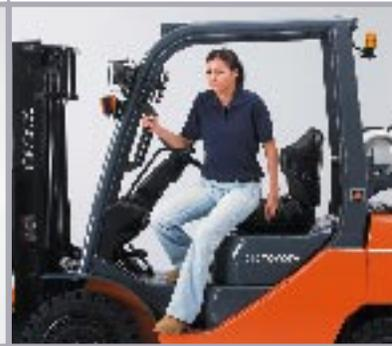
▲ **Le système de détection de présence de l'opérateur (OPSS)** interdit à ce dernier l'utilisation des fonctions hydrauliques ou la conduite du chariot s'il n'est pas assis à sa position normale de travail.
