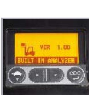
▲ L'affichage numérique multifonctions en option offre des **capacités d'autodiagnostic avec analyseur incorporé** qui permettent de se passer d'un outil de diagnostic manuel.
