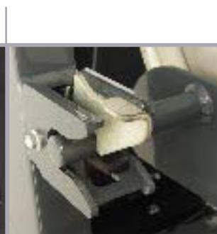
▲ **Le verrouillage du support de réservoir BP à une touche avec œillets en caoutchouc** permet de déverrouiller/verrouiller le réservoir BP d'une seule manœuvre tout en absorbant les bruits dus aux vibrations lorsque le chariot passe sur des surfaces inégales.
