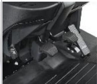
▲ **Les pédales indépendantes de frein et de commande d'approche lente** garantissent une excellente puissance d'arrêt et un positionnement précis du chariot élévateur.
